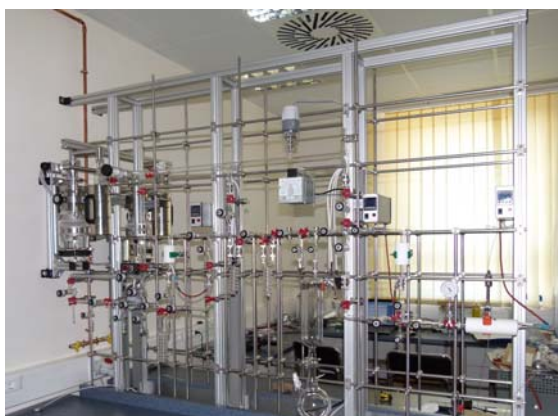
3. ábra: A HEKAL-ban fejlesztett on-line AMS ^{14}\text{C} mintaégető és gáztisztító rendszer
