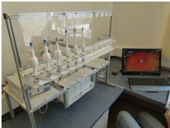
2. ábra: A HEKAL saját fejlesztésű automatizált csonttisztító ABA rendszere
