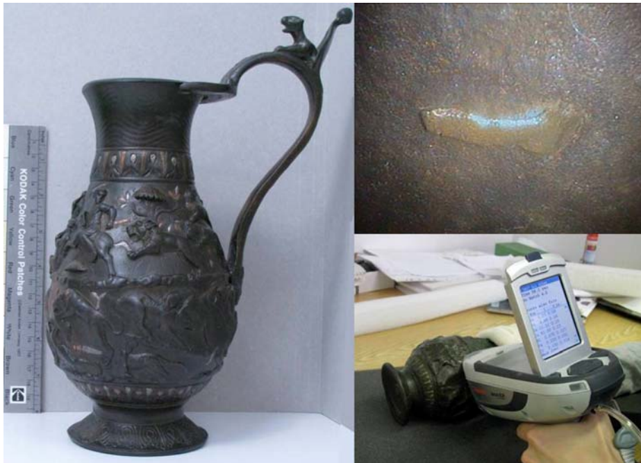
4. ábra: 1, Avar kori díszített bronz edény, Budakalász (PMMI 93.2.1.) 2, A készítés technikájára utaló nyomok a korsó belső felületén, száloptikás eszköz segítségével készített digitális felvételen 3, a díszítő elemek összetételének vizsgálata kézi XRF készülékkel vizsgálata (Maly Z. vizsgálata, MTA-GKKI)
