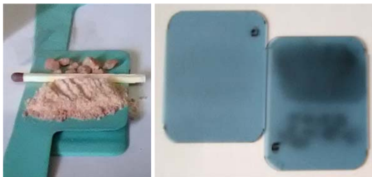
7. ábra. Két film között egy használt film, rajtuk a K_2O és a filmekken megjelenő feketedések 104 nap után.
