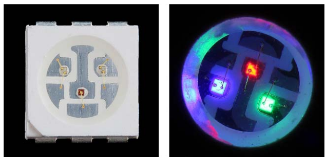
1. ábra. A kék, zöld, vörös (RGB) LED-ek közvetlenül sugároznak.
