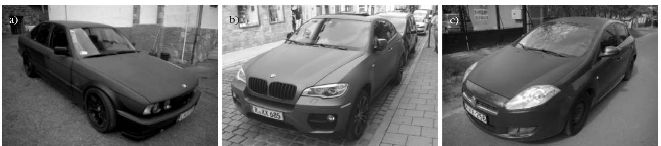
2. ábra. Matt fekete (a) és matt szürke fényezésű (b), illetve matt karbonfóliával ellátott tetővel és motorháztetővel rendelkező autó (c) Horváth Gábor felvételein.
