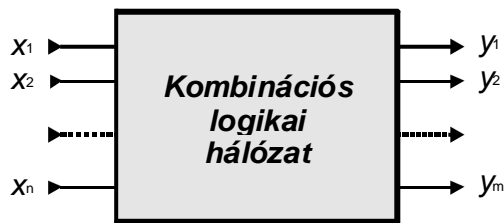
3. ábra Kombinációs logikai hálózat tömbvázlata
