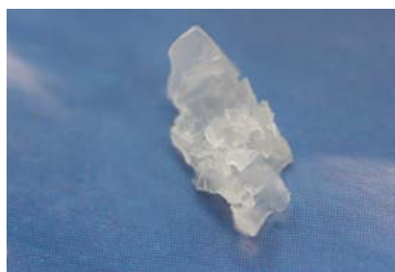
9. ábra A P((EO)_2-MA)-b-PIB-b-P((EO)_2-MA) blokk-kopolimer szegmensök összekapcsolásával kapott kotérháló fényképe
