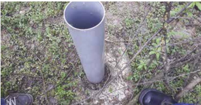
Lezáratlan monitoringkút (a PVC-rakát védelmét biztosító acélsövet és a zárósapkát eltulajdonították) (a szerző saját felvétele, 2019)
