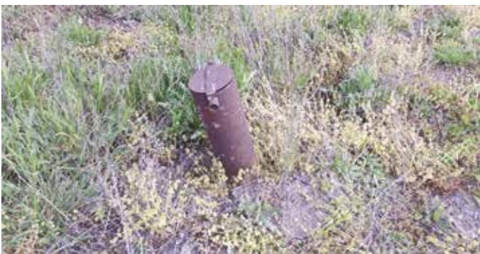
Részben „kiszántott” monitoringkút (a szerző saját felvétele, 2019)
