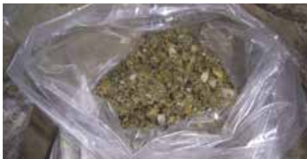
2. kép: A kutak által szűrőzött vízáadó réteg jellemző szemcseösszetétele a T-13. jelű kút szelvényében (a szerző felvétele, 2014)
