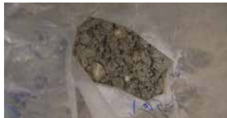
3. kép: A termeltetett vízáadó réteg jellemző szemcseösszetétele a T-15. jelű kút szelvényében (a szerző felvétele, 2014)
