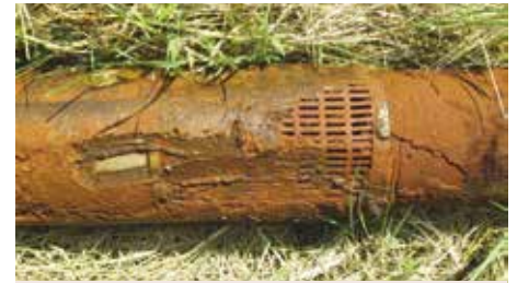
6. kép: Vas- és mangán-oxid-csapadék a kútból kiépített búvárszivattyún (BÁCSVÍZ Zrt., 2009)
