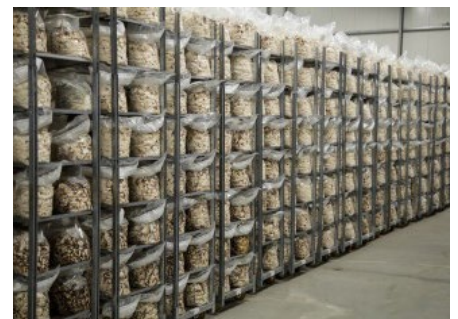
8. ábra: Micélium alapú szerkezeti anyagok egy átszövető hangárban. Forrás: MOGU
