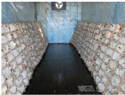
4. ábra: Téved, aki azt hiszi, egzotikus gyógygomba termesztést lát a képen. Kisüzemi micélium-tégla gyártás folyik egy konténerben az építőipar számára. Forrás: Mycworks
