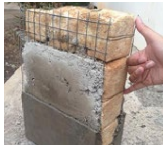
6. ábra: Szigetelőfal micéliumból Forrás: Micote.ch
