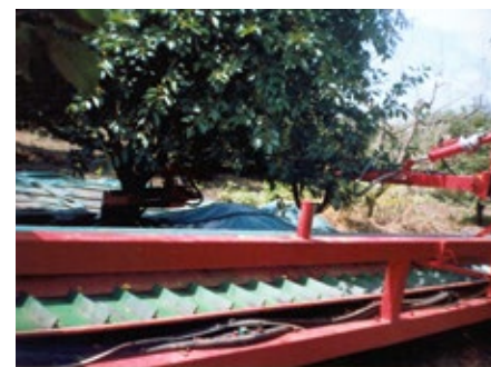
7. ábra. Keresztbordás hevederszalaggal ellátott LIPCO típusú vontatott rázó-gépet (Forrás: saját felvétel)
