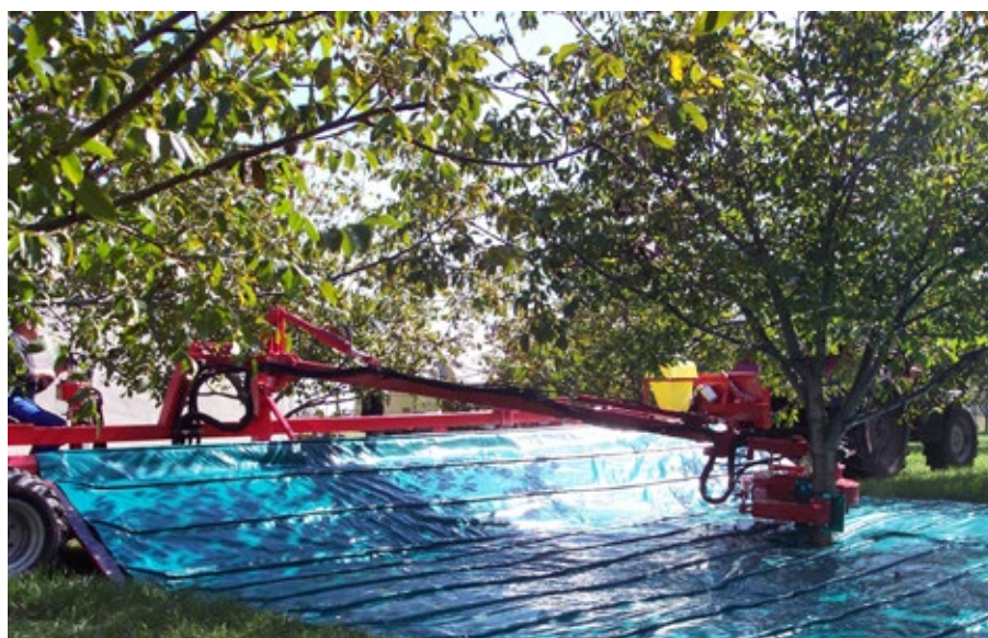
6. ábra. Felfogóernyővel ellátott LIPCO típusú lökőrudas rázógépet betakarítás közben (Forrás: Bartifarm Kft.)
