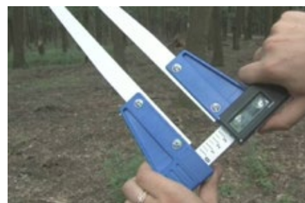
1. ábra: CODIMEX digitális faátlaló
