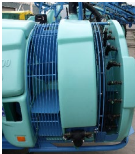
8. ábra. Axiál ventilátoros függesztett és vontatott permetezőgép (Forrás: saját felvétel)
