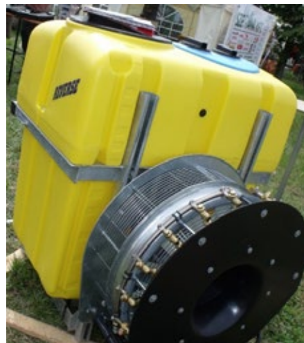
8. ábra. Axiál ventilátoros függesztett és vontatott permetezőgép (Forrás: saját felvétel)
