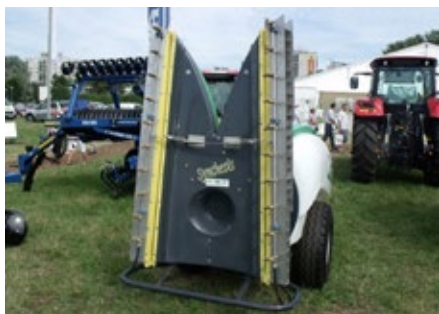
9. ábra. Szőlőültetvényben használt axiál ventilátoros vontatott permetezőgép (Forrás: saját felvétel)
