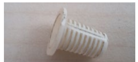
4. ábra. Szívószűrő és a csaprendszer (a), illetve az elemi szűrő (b) (Forrás: saját felvétel)
