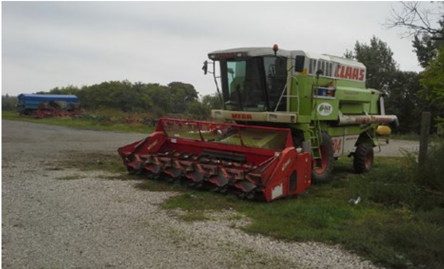
4. ábra. Claas Mega típusú betakarítógép napraforgó adapterrel (Forrás: saját felvétel)
