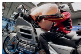
Motorkerékpárra szerelt légszák
