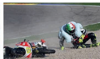
Motorkerékpár-versenyzőre telepített légszák
