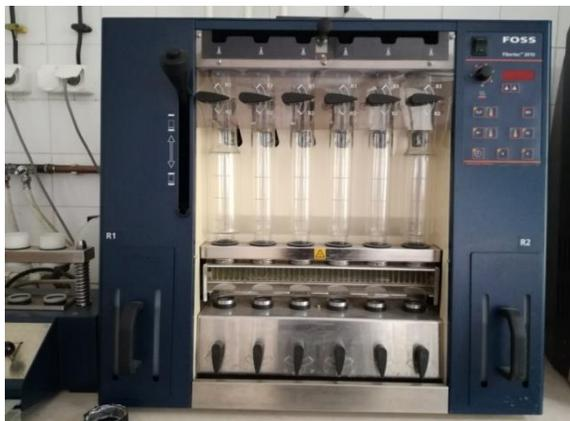
*Figure 5. 2010 Fibertec System*
