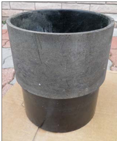
3. ábra Hőszigetelő elem bakelitből
