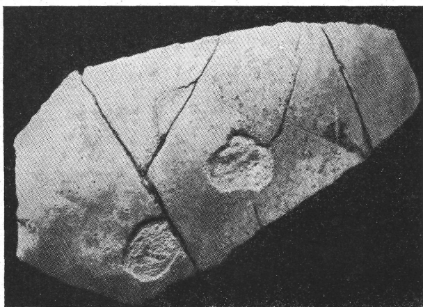
1. kép. Aranyozott cserépdarab lefagyás jeleivel
