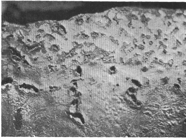
5. kép. Az aranyréteg alatt levő máz hibáit az aranyozás nem tudja eltüntetni
