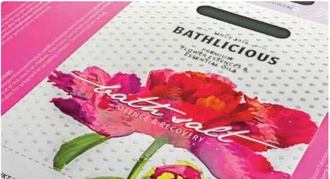
„Bathlicious” fürdőszó hajlított doboza UV-inkjettel nyomtatva. A digitális felületnemesítés inline történt a DEU egységben 32 g/m 2 fényes UV-lakkal (Forrás: pack.consult)
