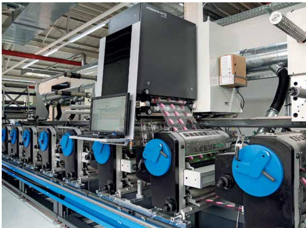
A Steinemann DPE Digital Printbar „White Edition”-ja, beépítve egy Gallus Labelmaster 440-be (Forrás: Gallus Ferd. Rüesch AG)
