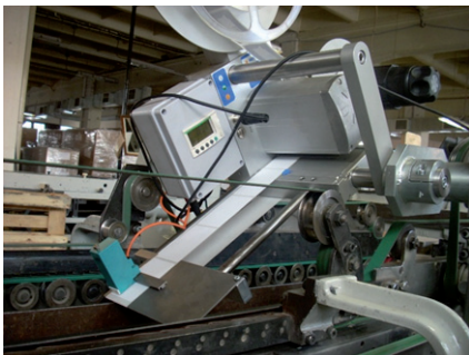
2. ábra A címkéző és a hajtogató gép együttes működése
