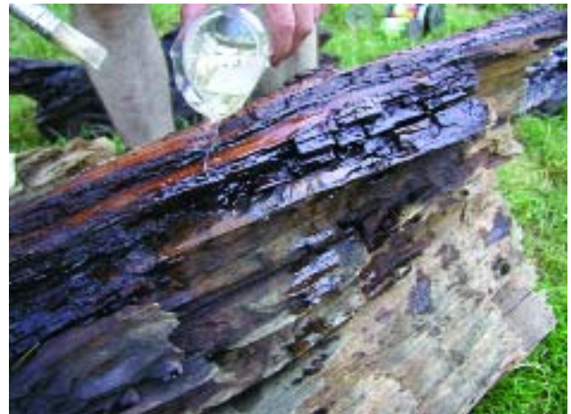
6. kép A faanyag szilárdítása
