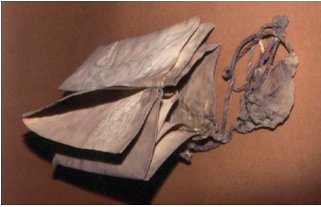
1. kép. Hő hatására megolvadt viaszpecsét és zsugorodott pergamen
