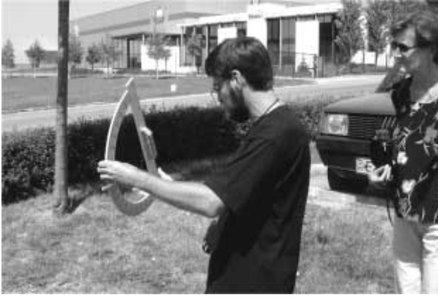
1. ábra. A szélességi kör meghatározása délben, szögmérővel
